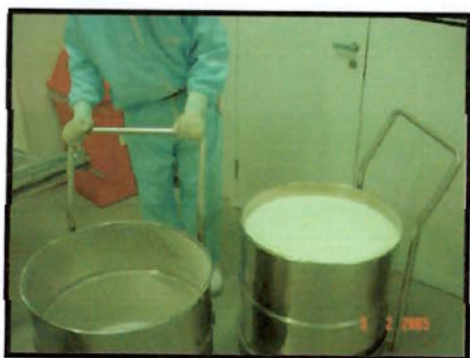
Fig. 14. Troca do tambor de matéria prima (granulado)
