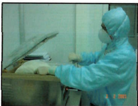
Fig. 16. - Fechamento à vácuo das embalagens plásticas dos comprimidos acabados
