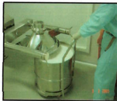
Fig. 13. – Colocação do tambor na torre de elevação
