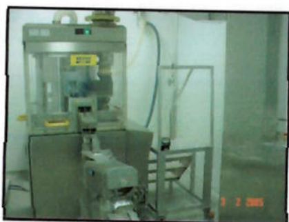
Fig. 8. – Vista geral da máquina compressora
